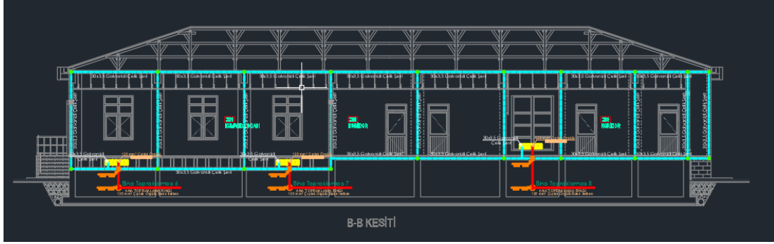
Şekil 30 : Kumanda Binası Topraklama Projesi
