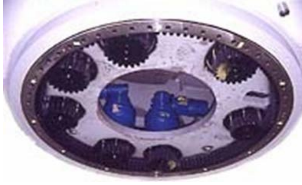
Şekil 24. YAW (yön saptırma) Mekanizması
