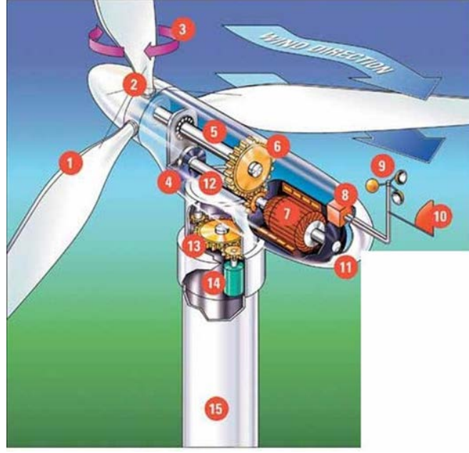
Şekil 21. Yatay Eksenli Rüzgâr Türbinlerinin Ana Elemanları
