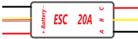
Şekil 2.15. Elektronik Hız Kontrolü Şeması
